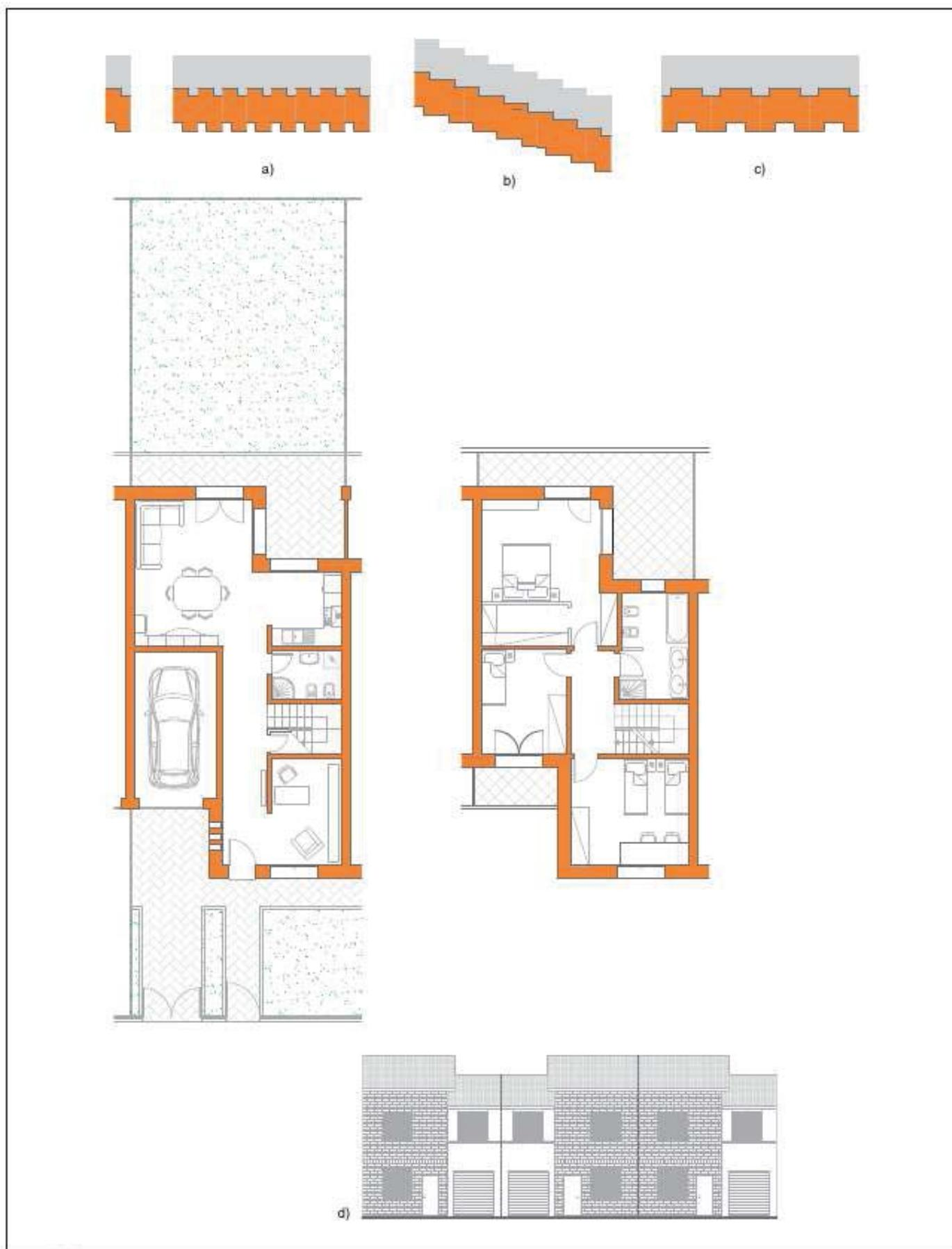
**FIGURA 7** Schemi di aggregazione di schiera a due piani (a-c). d) Esempio progettuale sviluppato secondo lo schema c).
