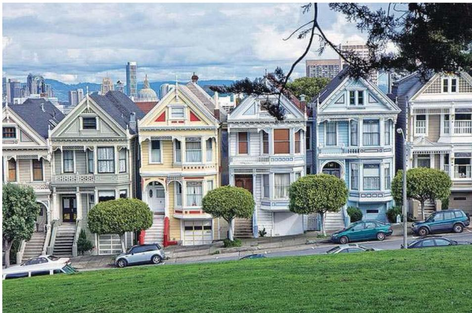
**FIGURA 5** Case a schiera di legno a San Francisco (Usa). Sono visibili l'autorimessa al piano terreno, le zone abitative ai piani primo e secondo e il sottotetto abitabile.
