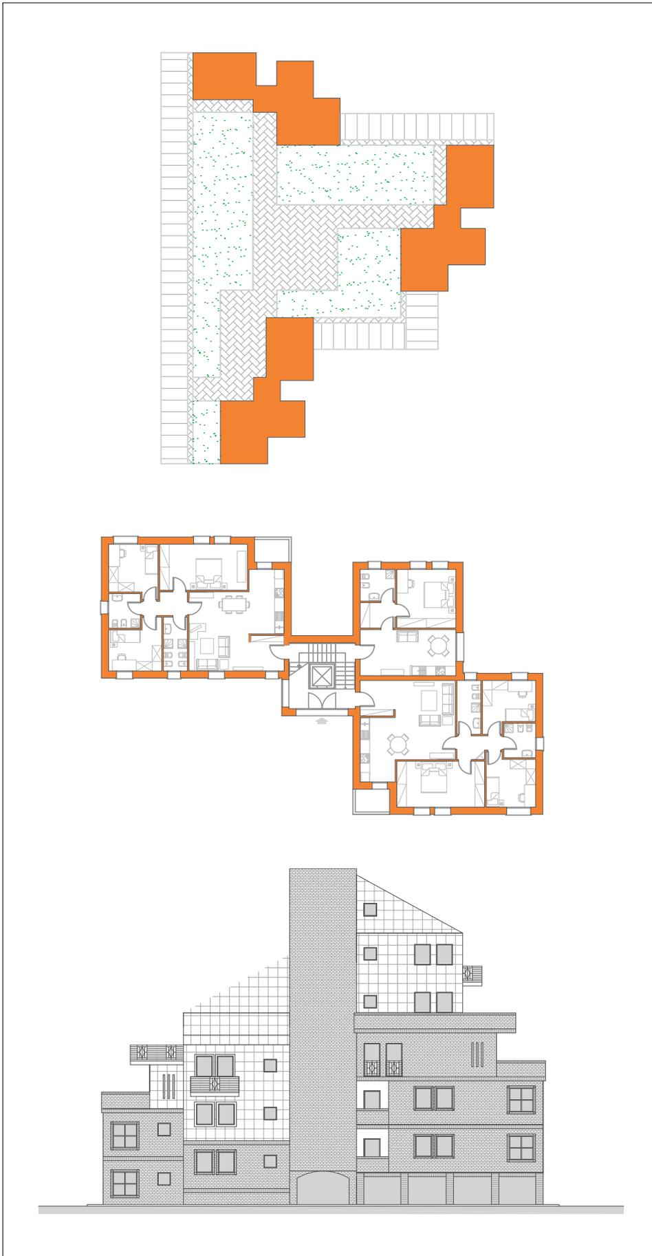
**FIGURA 14** Gruppo di edifici a torre. Dall'alto: planimetria dei fabbricati, della viabilità e delle parti comuni esterne; pianta del piano tipo; prospetto.
